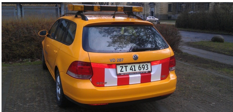
Figur 7.65 Eksempel på afmærkning af tilsynskøretøj med lygtebro og lodrette rød/hvide reflekser som spærrebom.
