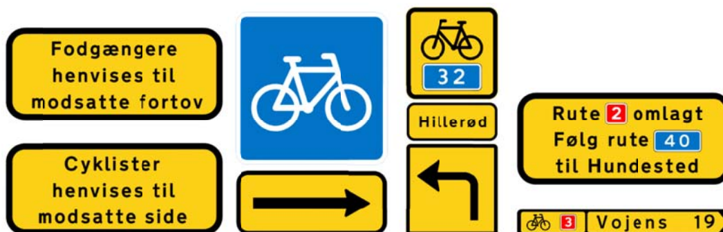
Figur 7.26 Eksempler på omkørselstavler for cyklister og fodgængere.
