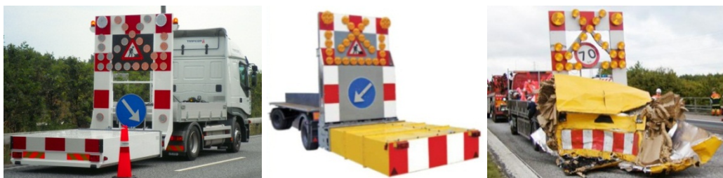
Figur 7.39 Eksempler på TMAer.
