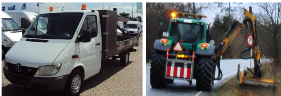
Figur 7.61 Eksempler på arbejdskøretøjer med afmærkningslygter.
