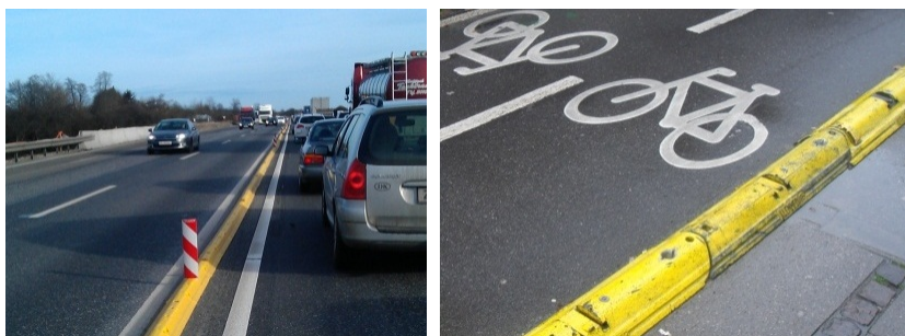
Figur 7.67 Eksempler på anvendelse af ledebjælke.
