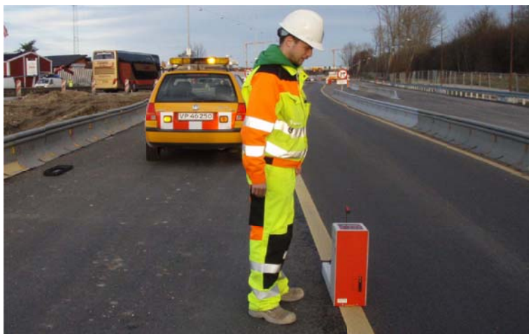
Figur 4.8 Eksempel på kontrol af kørebaneafmærkningens retrorefleksion ved anvendelse af retrometer.
