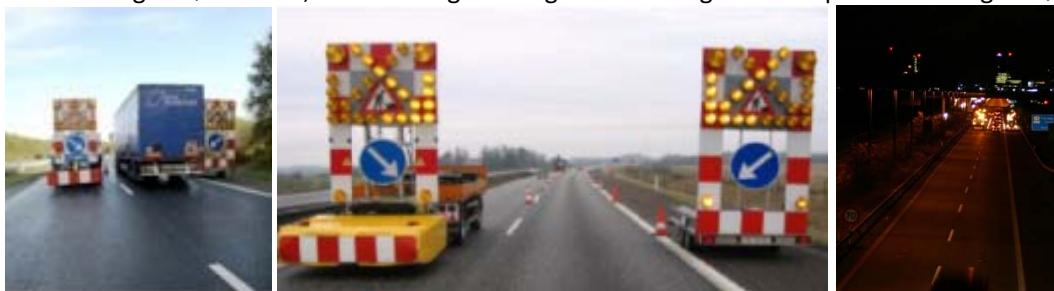
Figur 7.60 Eksempler på portopstillinger med afmærkningsvogne.
