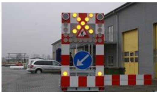
Figur 7.38 Eksempel på afspærringsvogn med sideforskydelig bom (skydebom).
